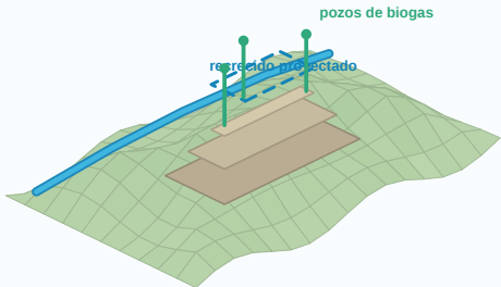
vaso en explotacion integrado en el entorno: bermas, recrecido y desgasificacion
